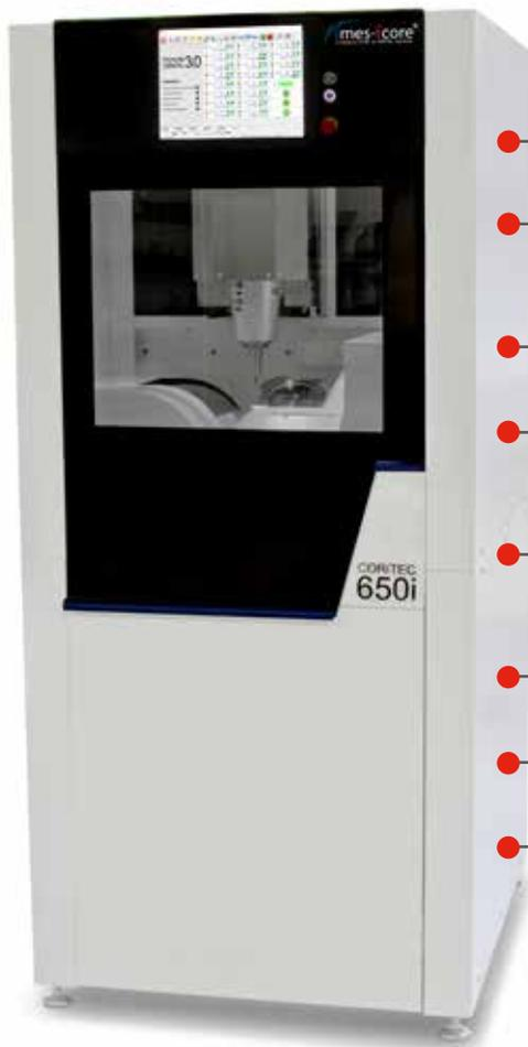
Massiver Achsaufbau aus geschliffenem Natur-Granit für 5-Achs-Simultan-Bearbeitung in hoher Dynamik für hochpräzise Fräsergebnisse
