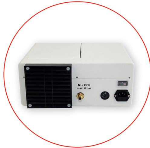
Das sehr leistungsfähige Universal-Polymerisationsgerät ist mit einem Schutzgasanschluss ausgestattet, wodurch die Sauerstoffinhibition an den Oberflächen verhindert wird.
